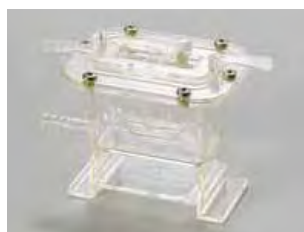
Temperierbehälter Probentemperaturung durch Anschluß an einen Wasserbadthermostaten
