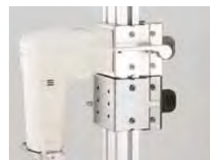
Positionierhilfe Verwendung zur Höheneinstellung der Sensoreinheit und der Sensorplatten bei wiederholten Messungen.
