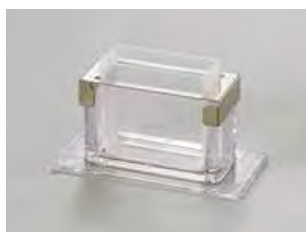
Quarzglasprobenbecher (ca. 13ml) Quarzglasbehälter zur Verwendung bei Messung von Lösungsmitteln, usw.
