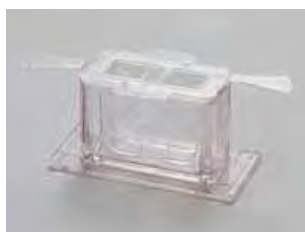
Kleiner Probenbecher (10ml) Verwendung zur Messung kleiner Probenmengen
