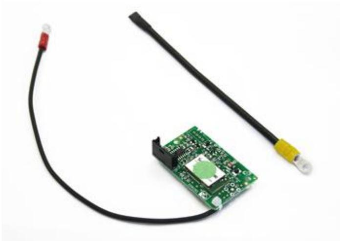
Schnittstelle, die ein RS232-Signal in eine Funk-Frequenz 868 MHz umwandelt. Bis zu 50 Übertragungskanäle, programmierbar mit PC-Software. Dank des geringen Energiebedarfs und der großen Übertragungsstrecke ist dieser Baustein ideal zum Aufbau mobiler Wäge-Systeme oder drahtloser Funk-Übertragung.
