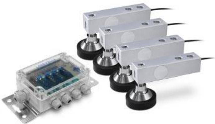
Ideal zum Bau einer eichfähigen Wäge-Plattform (OIML und NTEP) mit 4 Wägezellen in verschiedenen Größen und Nennlasten. Ein Kit besteht aus 4 vernickelten Scherstab-Wägezellen à 350 Ohm, Schutzart IP67, 4 höhenverstellbaren Füßen und einem Anschlusskasten.
