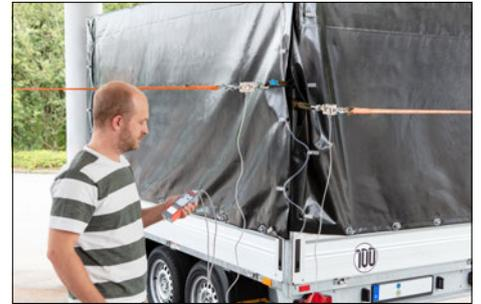
Messen von Kräften in verschiedenen Zug- oder Druckrichtungen mit nur einem Messgerät möglich
