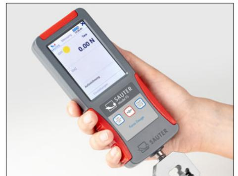
Kompaktes Kraftmessgerät mit interner Messzelle (bis max. 500 N) für schnelle und mobile Kraftmessungen. Abbildung zeigt optionales Zubehör Schraubklemme SAUTER AE 500
