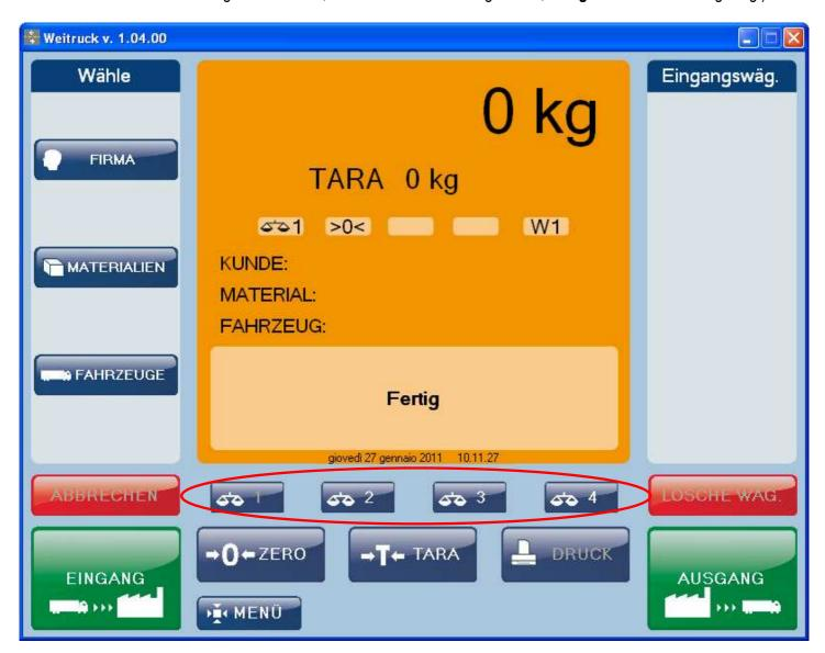
Falls ein Kommunikationsproblem mit der Waage auftritt, wird die Nachricht (**WAAGE WECHSELN NICHT ERFOLGREICH)** angezeigt).
