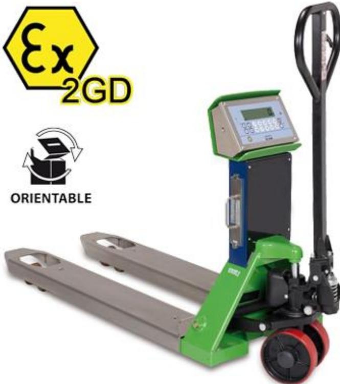
Gabelhubwagen mit Waagenfunktion, geeignet für den Einsatz in explosionsgefährdeten Bereichen (ZONEN 1 und 21 & 2 und 22), ATEX-Kennzeichnung Ex II 2G IIB T4 Gb X und Ex II 2D IIIC T197°C Db X. Die Lastaufnahme über 4 ATEX-zertifizierte Wägezellen garantiert optimale Wägeregebnisse in allen Betriebsarten. Verfügbar auch in eichfähigen Versionen (CE-M).
