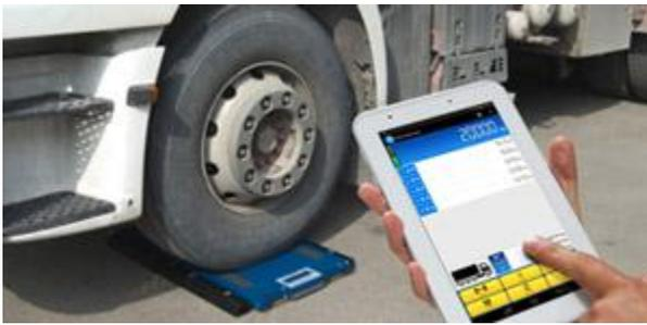
Beispiel: Anwendung einer Wireless-Plattform, mit Option WWSDUAL mit analoger Plattform, Bluetooth BLTH und der App "DINI SMART AXLE Weighing".
