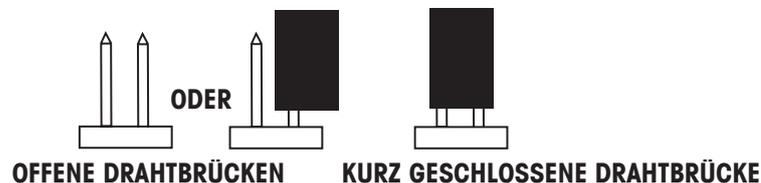
Abbildung 2-2. Drahtbrückenanschlüsse
