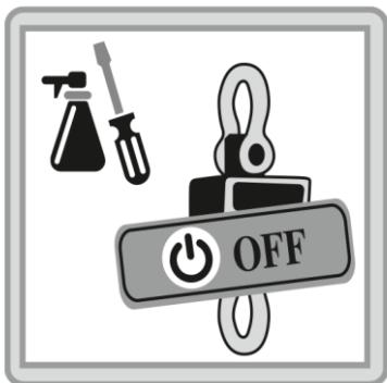
Toute opération d'entretien, la réparation ou le nettoyage doit être effectuée au crochet peseur éteint
