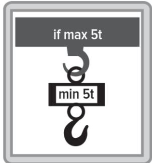
La portata nominale del dinamometro non deve essere inferiore alla capacità massima del sistema di sollevamento.
