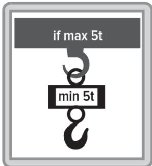
Die Nennlast der elektronischen Kranwaage darf nicht kleiner sein als die maximal zulässige Last der Hebevorrichtung.
