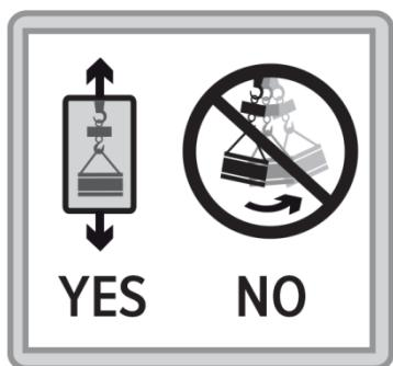
Verwenden Sie die Waage ausschließlich zum Heben und Wiegen von Lasten oder für Zugkraftmessungen.
