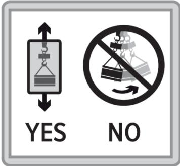
Il est INTERDIT d'exécuter des tractions obliques de la charge.
