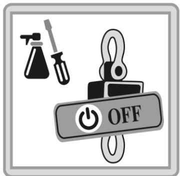
Qualsiasi operazione di manutenzione, riparazione o pulizia deve essere eseguita con il dinamometro elettronico spento
