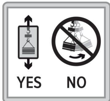
Utiliser la balance SEULEMENT pour lever et peser des charges suspendues et pour relever des mesures à la traction.
