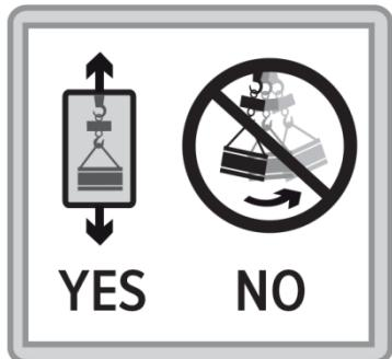
Utilizzare la bilancia ESCLUSIVAMENTE per il sollevamento e la pesata di carichi sospesi e per misure a TRAZIONE.
