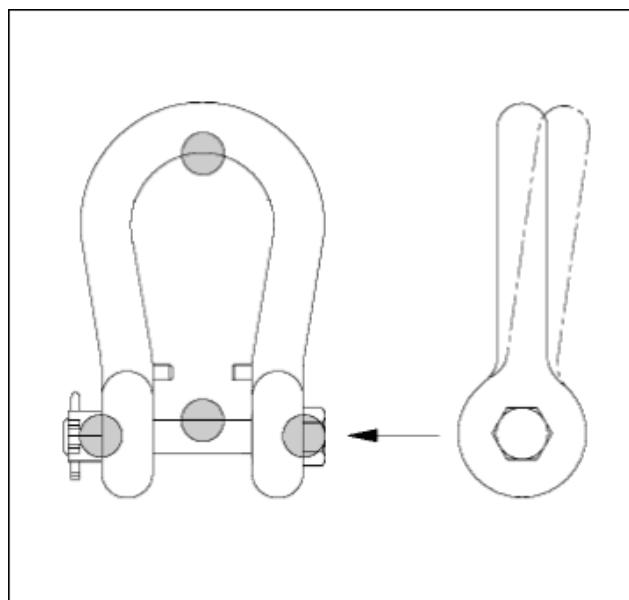
Die Schäkel müssen regelmäßig von einem Fachmann überprüft werden. Der Zeitabstand zwischen den einzelnen Inspektionen hängt von der Benutzungshäufigkeit des Geräts ab; es wird empfohlen alle 6 Monate.
