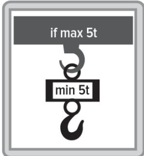
La charge utile du dynamomètre ne doit pas être inférieure à la charge utile maximum du système de levage,
