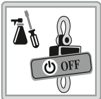
Jegliche Wartungs-, Reparatur- oder Reinigungsarbeiten nur bei ausgeschalter elektronischer Kranwaage durchführen.
