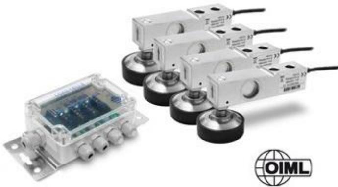
Ideal zum Bau einer eichfähigen Wäge-Plattform (CE-M) mit 4 Wägezellen in verschiedenen Größen und Nennlasten. Ein Kit besteht aus 4 Edelstahl-Wägezellen à 1000 Ohm, Schutzart IP68, 4 höhenverstellbaren Edelstahl-Füßen und einem Anschlusskasten.
